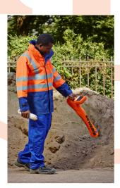
"metodo a 45°" (triangolazione): permette di localizzare e misurare la profondità del tubo anche quando ostacoli ne impediscono l'accesso diretto
